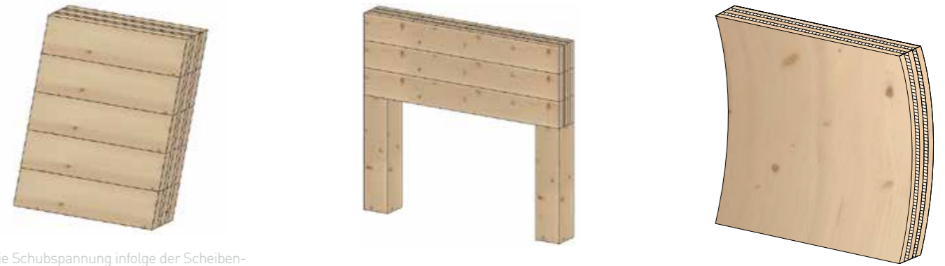
Die Schubspannung infolge der Scheiben-schubbeanspruchung könnte lt. B1995-1-1:2015 berechnet werden
